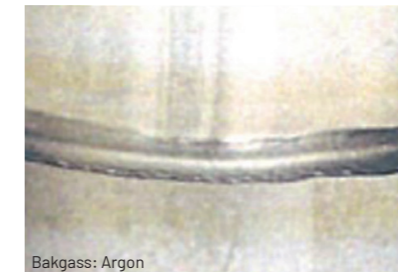
Oksydering av overflate på rotside, UNS-S32750. Restoksygenniå 35 ppm
