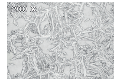
Mikrostruktur i SAF 2205 sveisemetall mot overflaten. Beskyttelsesgass: Argon
